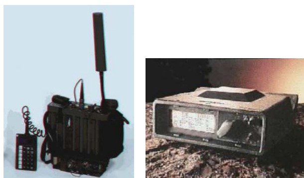
图 2 Manpack 接收机和 SLGR 接收机
