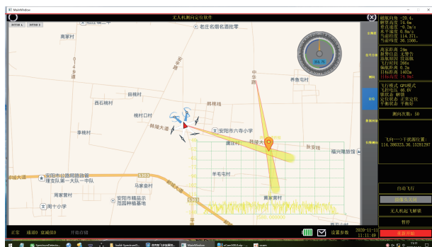
图 10 飞行 L 型轨迹后的第二个地点对干扰源进行测向并交叉定位
