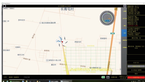
图 9 选定第一个地点对干扰源进行测向
