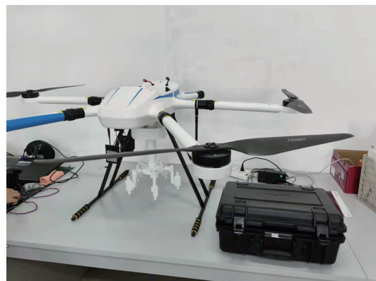
图 1 基于六旋翼无人机平台的 GNSS 干扰源测向与定位系统
